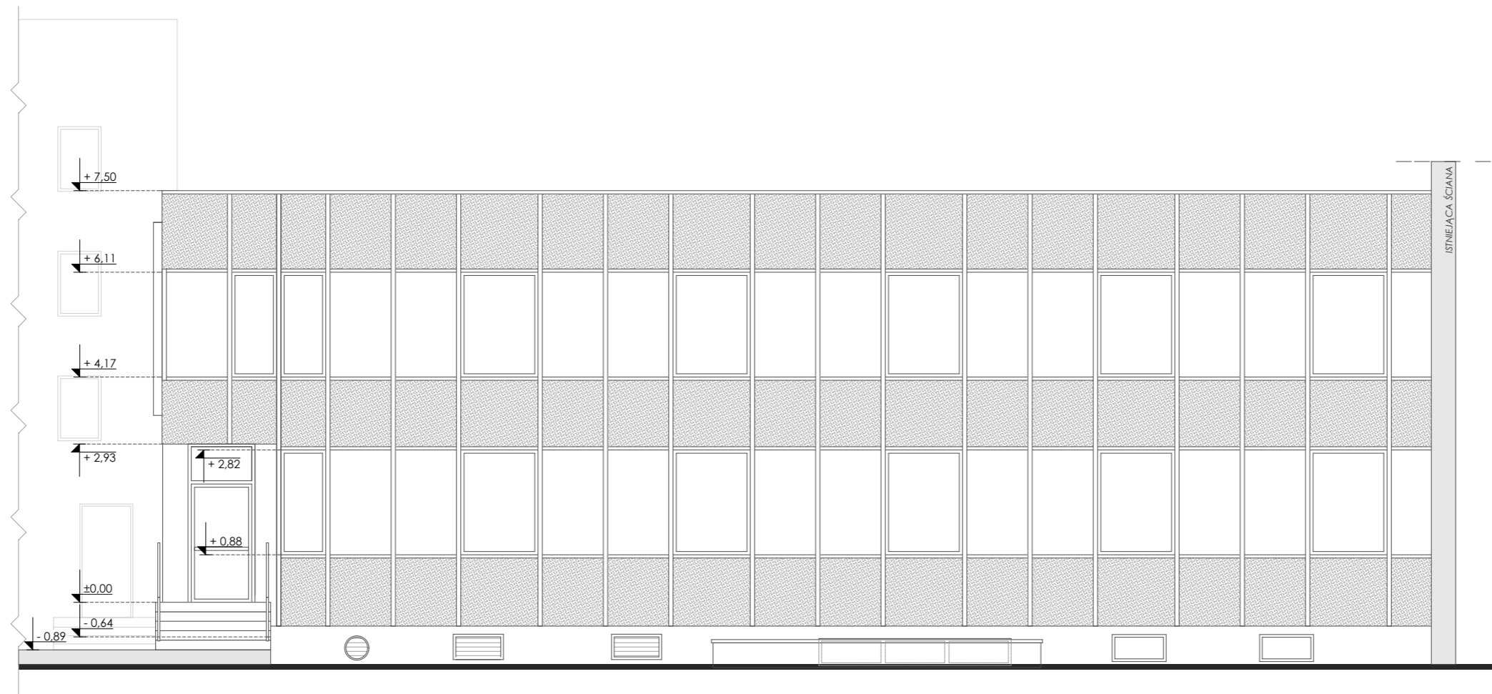
ELEWACJA PÓŁNOCNO - WSCHODNIA - stan istniejący
